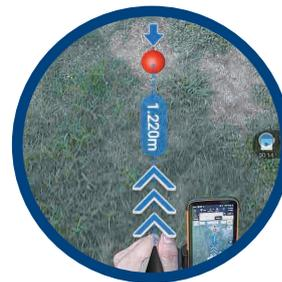
Совместная работа ГНСС, IMU и камер
